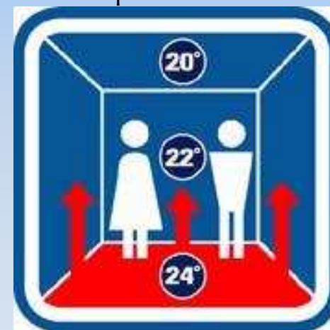
Ηλ. Ενδοδαπέδια Θέρμανση
